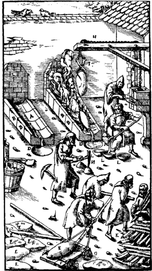
Wytapianie ołowiu i formowanie bochnów, na podstawie G. Agricoli De re metallica libri XII , Bazylea 1556 (ryc. 4)
