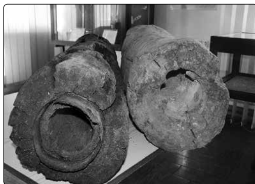
Rury drewniane (w zbiorach Muzeum Wody przy Stacji Uzdatniania Wody PWiK Sp. zo. o. w Olkuszu). Fot. J. Niewdana
