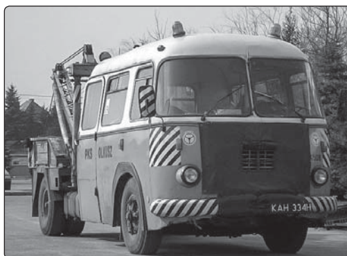
Il. 11. Jelcz 043 „Ogórek” pogotowie techniczne z PKS Olkusz. Powstał przez ucięcie tyłu seryjnego autobusu. Przez wiele lat służył jako bolownik zepsutych na trasie autobusów olkuskiego PKS-u. Zdjęcie ze strony: phototrans.eu
